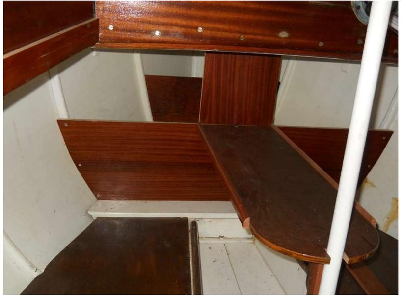
*Réalisation du capot, panneau de roof et aménagement intérieur.*
